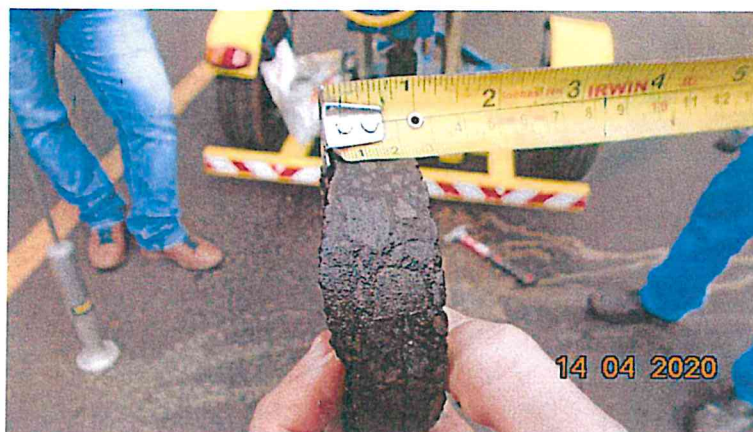
Figura 13 – Corpo de prova nº 12 - Rua Palometa (Apenas a capa)
