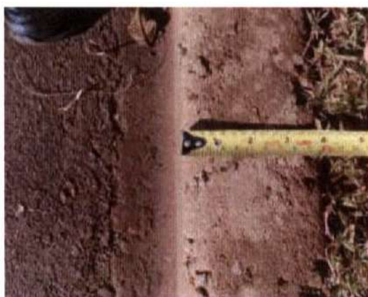
Figura 18 – Medição da largura superior (9cm).
