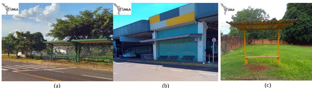
Figura 17 – Fotos dos três pontos de ônibus utilizados no sistema de transporte coletivo em Foz do Iguaçu. Foto a) é ponto com estrutura e telhado metálico, foto b) é o ponto de ônibus do aeroporto internacional de Foz do Iguaçu e foto c) ponto de ônibus simples com estrutura metálica e telhado tipo fibrocimento.
