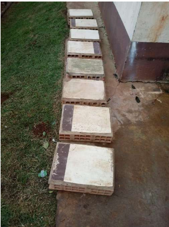
Figura 2 – Corpos de prova removidos das paredes.
